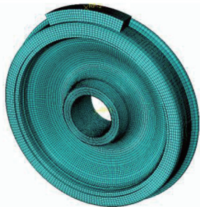
图 1 车轮-闸瓦摩擦副有限元模型 Fig. 1 Finite element model of wheel and brake shoe friction pair
